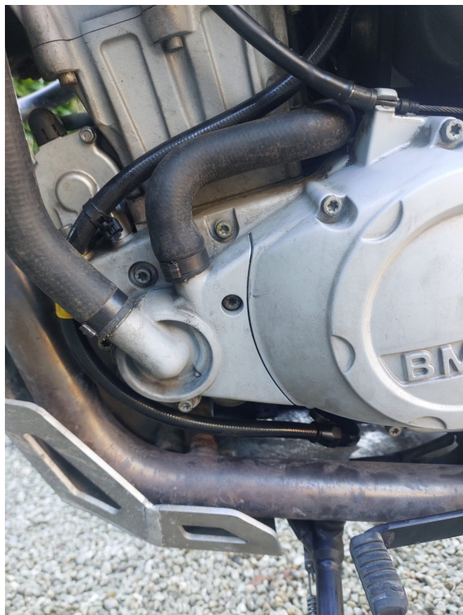
Abb.2: Verlauf der Stahlflex Ölleitung
